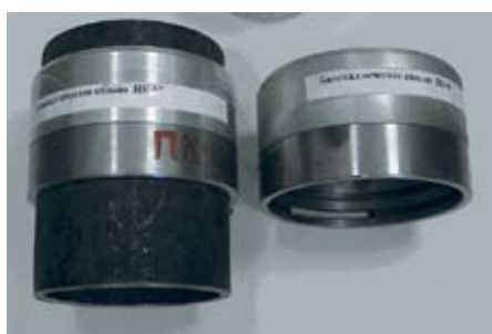
Рис.2. Внешний вид биметаллических колец ПК-Б «, (на трубе D 168 мм) позволяющих создавать участки «гарантированного сцепления» в сочетании с пеноцементной технологией.
