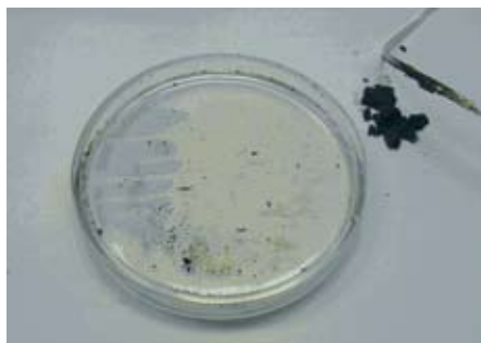
Рис 7. Удаление блокированной нефти механическим способом с водной поверхности. Поверхность без пленки нефти.
