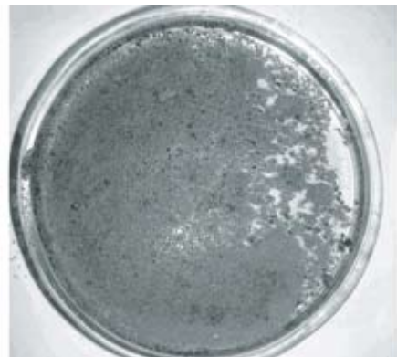
Рис 6. Блокирование нефти на водной поверхности сухой смесью ГВС.
