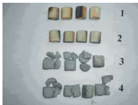
Рис.3. Образцы 1-4 цементного камня Ø18мм после 10 циклов (с 20 °C до 320 °C) термического воздействия. Где: рецептуры 1-2 предлагаемые к внедрению и разрабатываемые, 3-4 проектные.
