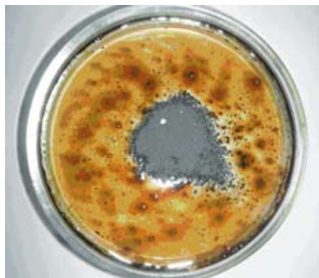
Рис 5. Нанесение сухой смеси ГВС на загрязненную нефтью водную поверхность.
