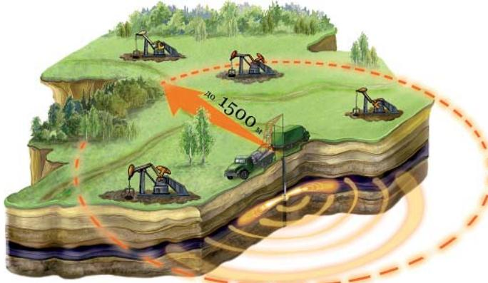
Рис. 1 Схема обработки эксплуатационных скважин производится плазменно-импульсным генератором
