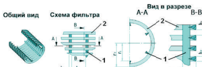
Рис. 1. Конструкция фильтра RBWWS
