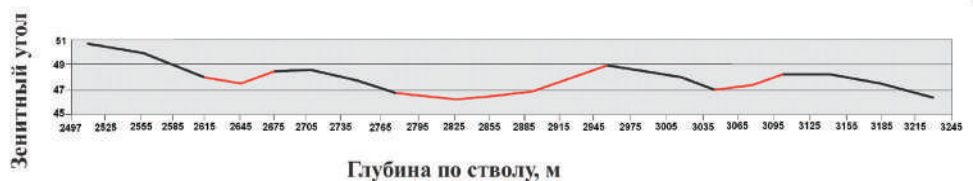
Рис. 4 Результаты инклинометрии ствола скважины в интервале бурения роторным способом компоновкой с управляемым центриатором Андергейдж
