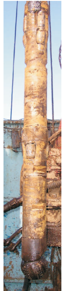
Рис. 4. Компоновка развальцевателей РР-120/130М2 и РРК-120/130 с одношарошечным долотом
