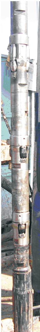
Рис. 3. Компоновка развальцевателей РР-110/120М2, РРК-120/130М2, РРК-120/130 с КПТ
