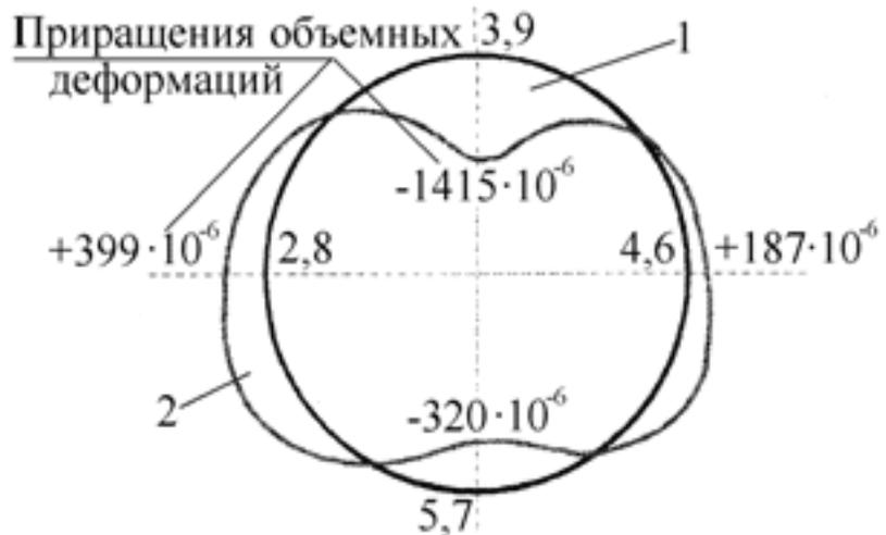
Рис. 2. Распределение приращения объемных деформаций (2) по периметру образца горной породы (1) при одноосном сжатии (аргиллит).
