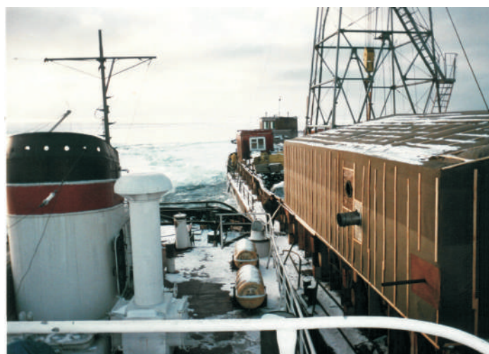
Рис. 6 Буровой комплекс "Недра-Байкал-2000" с судном сопровождения
