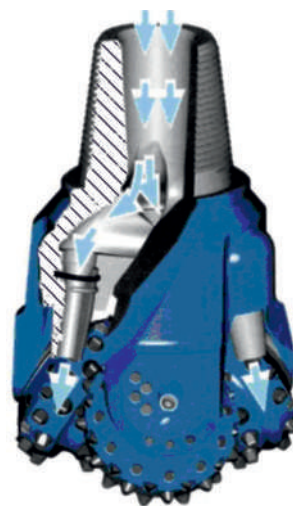
Рис. 1. Долото с боковым расположением каналов промывочной жидкости
