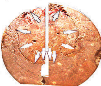
Рис. 5 Поверхность основания образца. Стрелками отмечены выходы конической трещины
