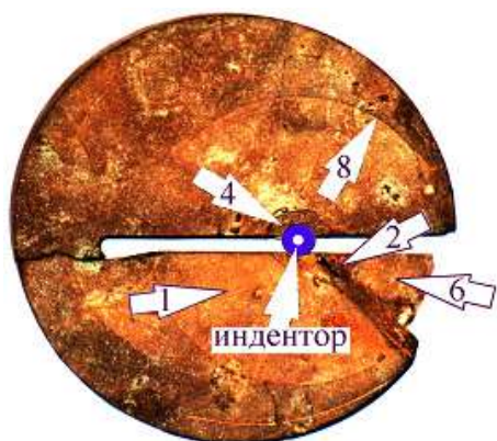
Рис. 3 Поверхность образца: 1 - консоль; 2, 6 - поверхности конических трещин; 4 - кратер; 8 - контур окружности выходящий на консольную трещину
