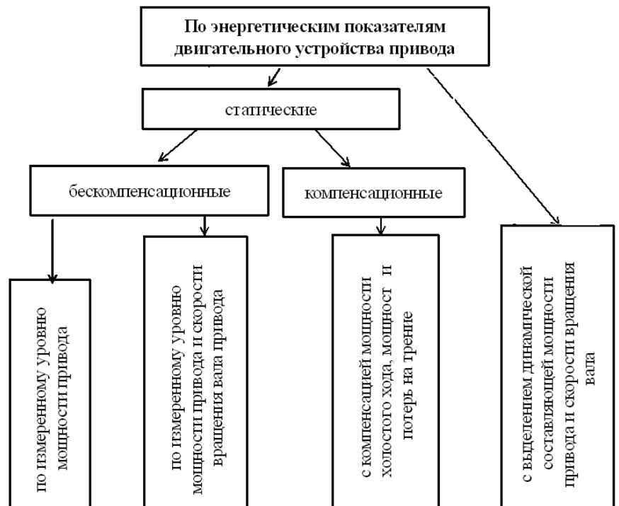
Рис. 2 - Классификация способов измерения крутящего момента по энергетическим показателям двигателя привода
