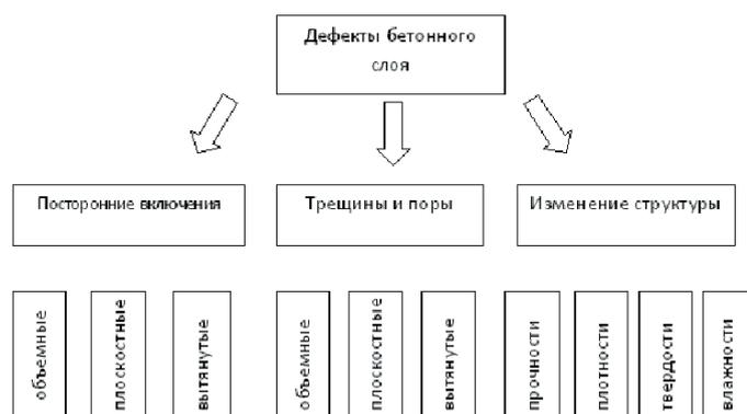
Рис. 2. Классификация дефектов бетона по виду и форме.
