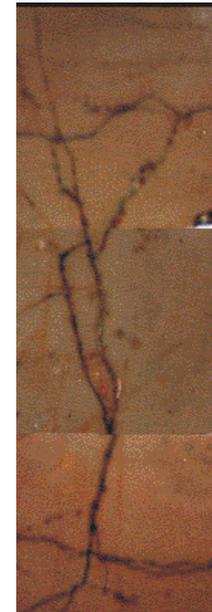
Скважина Юр-5Б. Глубина 2234,1+3,5 м. Доломит фитогенный, тонкозернистый, трещиноватый. По трещинам — рудный, частично окисленный.
