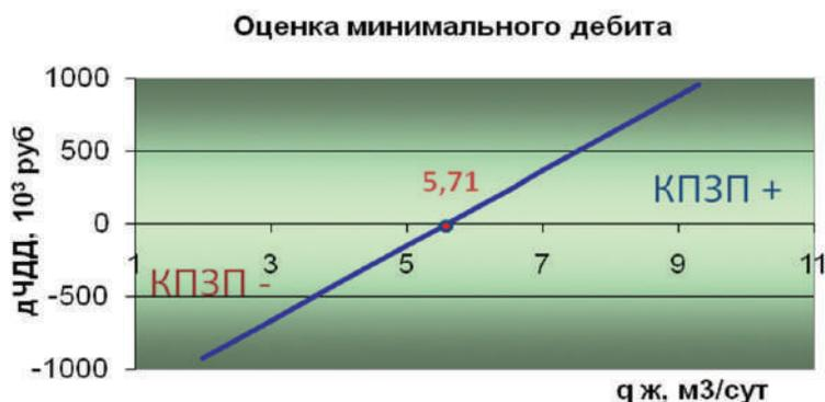
Рис. 2. Определение минимального дебита скважины.
