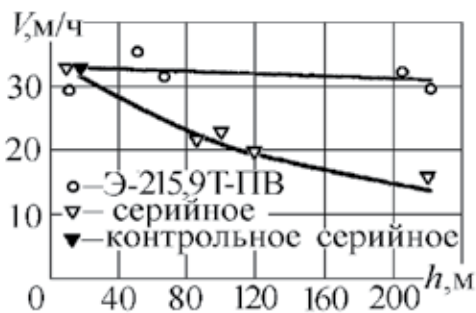
Рис.3. Влияние суммарной проходки на скорость бурения.
