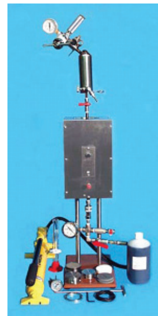
Рис. 1. Тестер проницаемости тампонирующего раствора производства OFITE (PPT – Permeability Plugging Tester).
