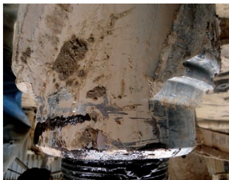
Рис. 2. Износа калибратора КС295,3СТ в течение более 200 ч в составе «маятниковой» КНБК состоящей из долота + УБТ-203 (1 труба) + КС295,3СТ при роторном бурении до глубины 1650 м скважины на севере европейской части России.
