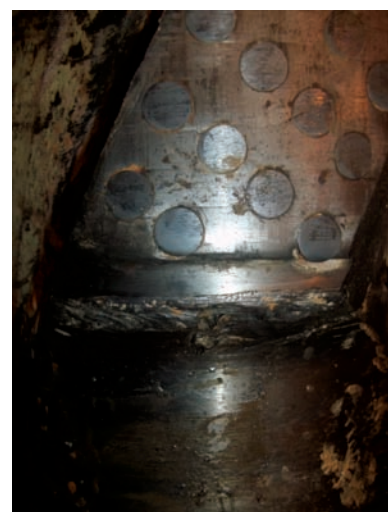
Рис. 1. Износ калибратора KC-214,3, установленного над УБТ-165 в течение 52 часов роторного бурения в условиях чередования алевролитов и песчаников.
