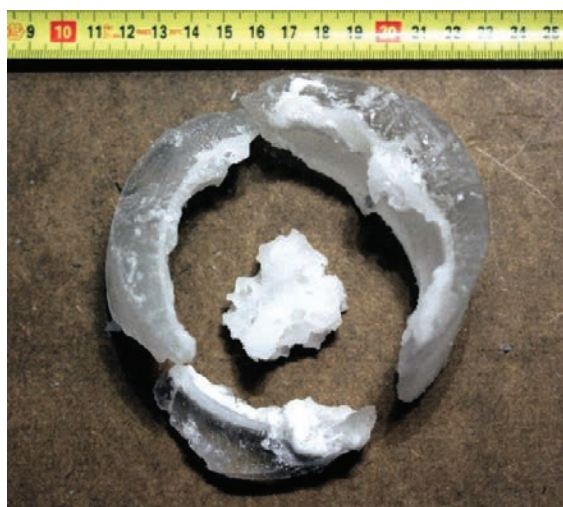
Рис. 2. Серповидные обломки нароста на стенке скважины 5Г-1.
