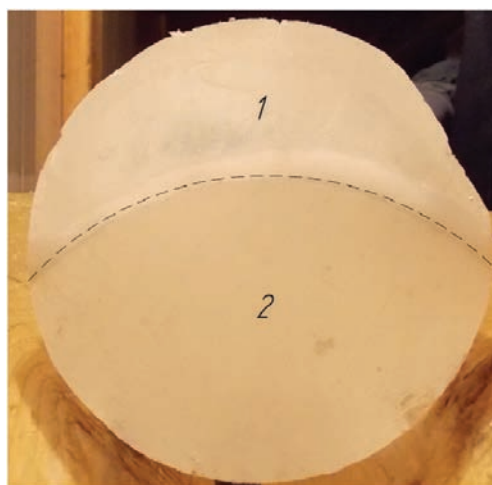
Рис. 4. Керн, полученный во время забуривания ствола 5Г-3 и содержащий серповидную часть атмосферного льда 1 – атмосферный лёд; 2 – замерзшая вода озера Восток.
