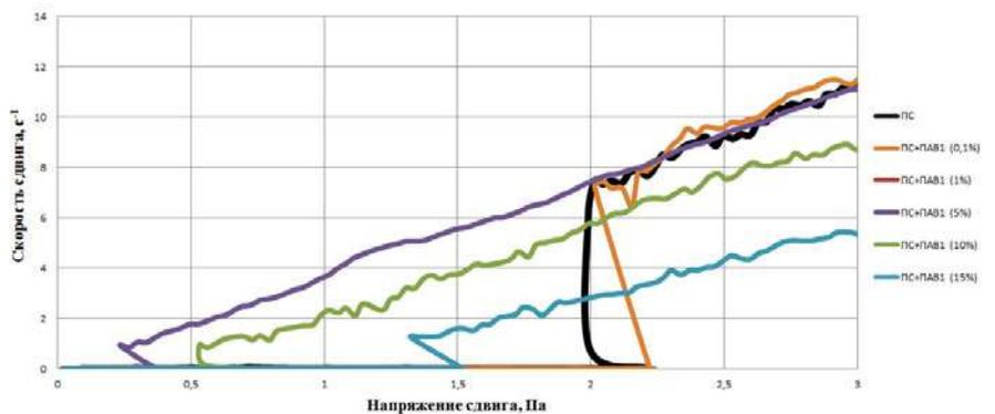
Рис. 2. Результаты экспериментов по определению реологических характеристик исследуемых составов при температуре 80 °С.
