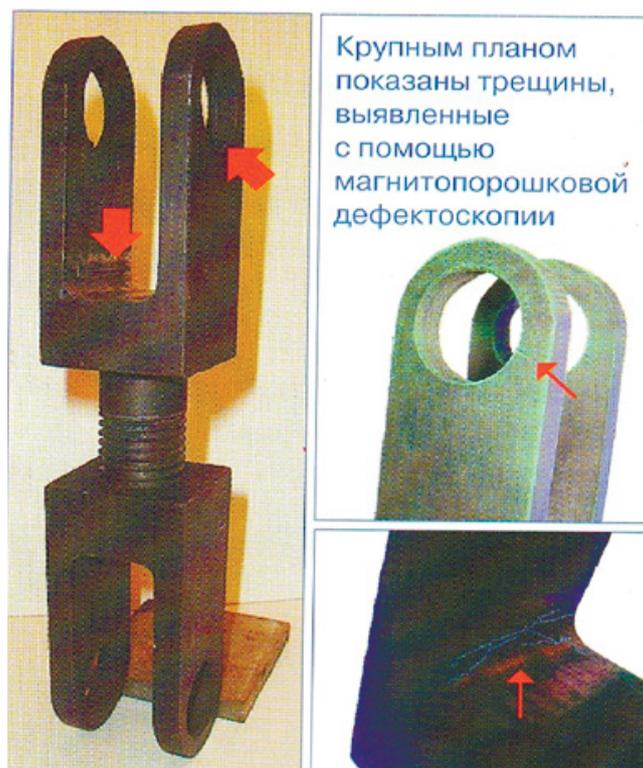
Рис. 5. Тормозная вилка агрегата УПА-60.
