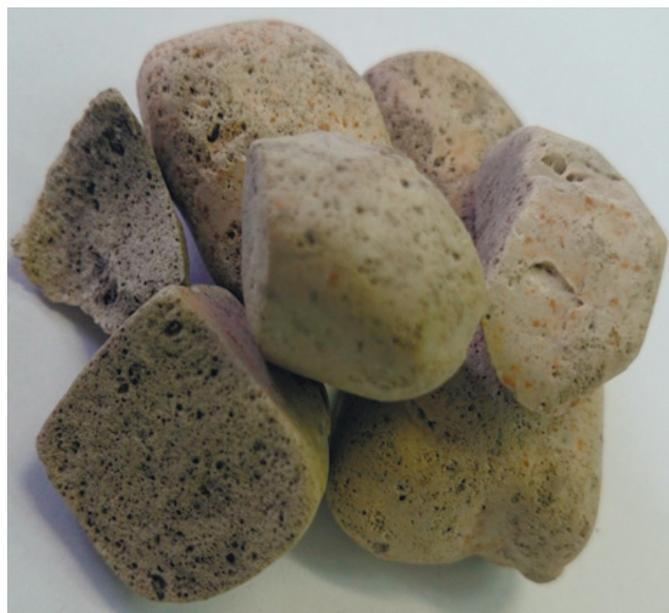
Рис. 1. Общий вид гранулированного пеностекла (размеры гранул от 0,4 до 1,5 мм).
