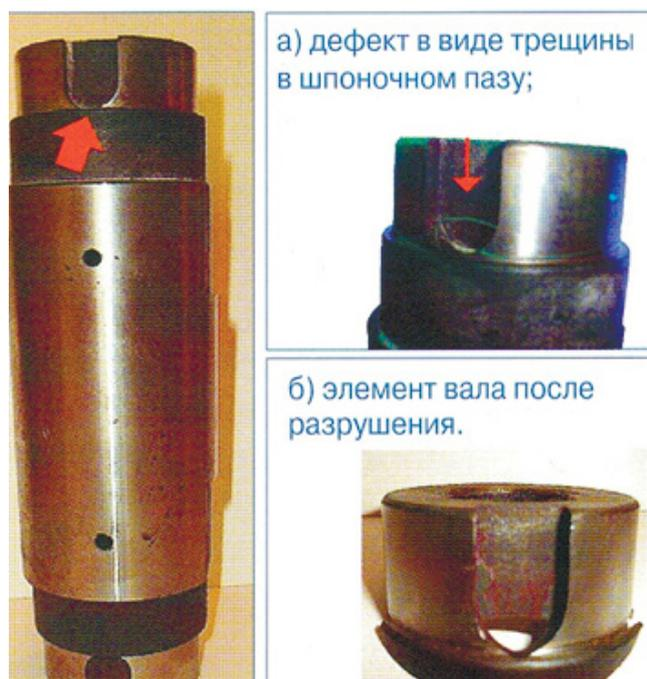
Рис. 4. Ось кронблока агрегата УПА-60.
