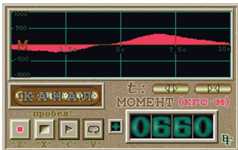
Рис. 8. Осциллограмма приращения крутящего момента при осевой нагрузке 12 кН.
