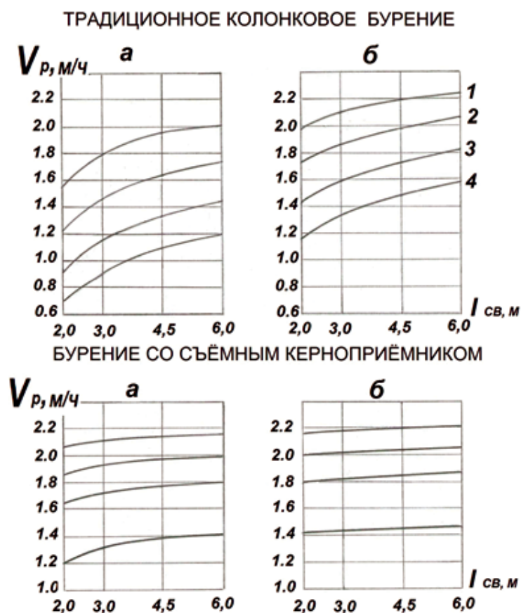
Рис. 2. Зависимость рейсовой скорости от длины свечи при механической скорости бурения 3 м/час а – один подвижный вращатель; б – два подвижных вращателя с совмещением СПО во времени; глубина скважины: 1 – 300 м; 2 – 500 м; 3 – 800 м; 4 – 1200 м.
