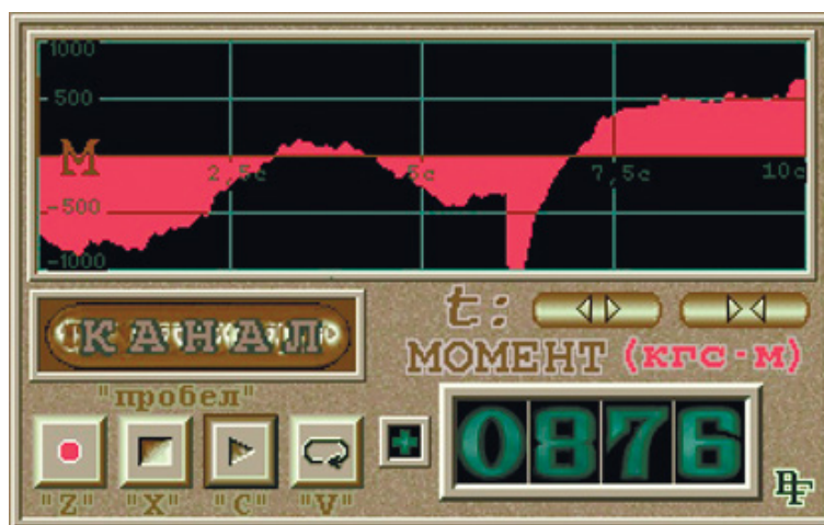
Рис. 7. Осциллограмма приращения крутящего момента при осевой нагрузке 120 кН.
