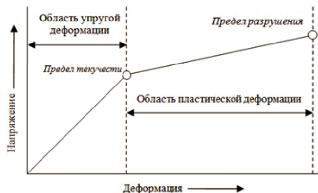
Рис. 2. Диаграмма зависимости деформации от напряжения.
