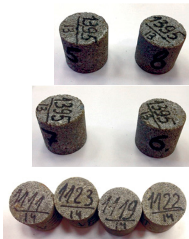
Рис. 2. Образцы керна, высверленные из образцов керна материала.
