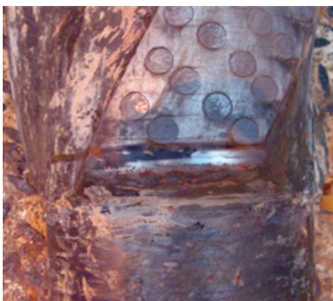
Рис. 5. Износ калибратора КС-214,3СТ на уступах в течение 52 часов роторного бурения скважины 1п-Шахринав в Республике Таджикистан.
