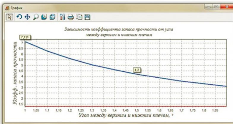
Рис. 3. График зависимости коэффициента запаса прочности (ось Y) от угла между плечами (ось X).
