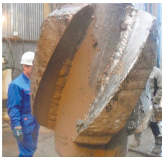
Рис. 8. Вид износа трехлопастного колонного калибратора с Ду-392 при бурении одной из скважин на Севере Европейской части РФ.
