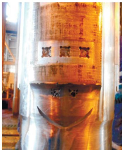
Рис. 4. Примеры износа элементов роторной управляемой системы (РУС) компании «Шлюмберге» после бурения в интервале чередования твердых и абразивных пород [3].
