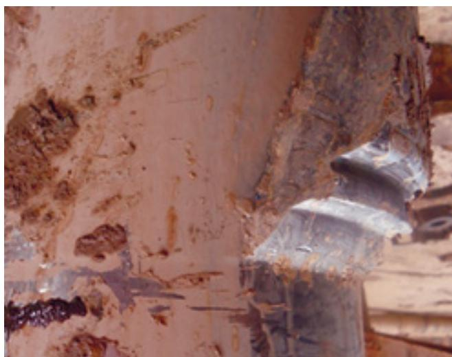
Рис. 7. Износ калибратора при роторном бурении в течение 350-400 часов до глубины 1650 м ствола с уступами в одной из скважин на севере Европейской части РФ с КНБК: долото 295,3 мм + УБТ-203 (1 труба) + КС295,3СТ.
