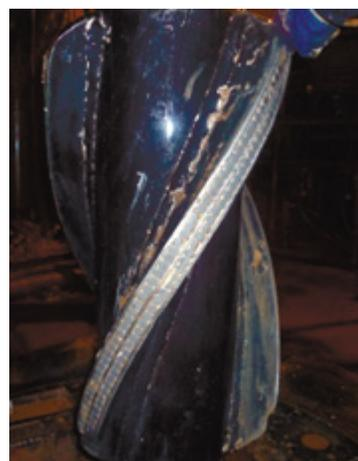
Рис. 6. Износ трехлопастного калибратора КС-392СТ после бурения интервала 851-2394 м одной из скважин на Западе Оренбургской области.
