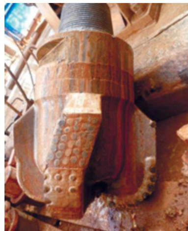
Рис. 9. Долото 393,7FD4I9SM-A288 производства ОАО «Волгабурмаш» с цилиндрической шейкой диаметром 280 мм.
