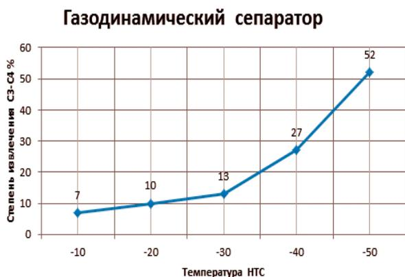
Рис. 2. Зависимость степени дегазации пропан-бутанов от температуры НТС.
